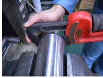
パイプレンチで廻す
