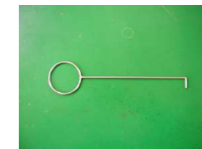
試料引揚げ治具 採取途中で上げる際に使用します
