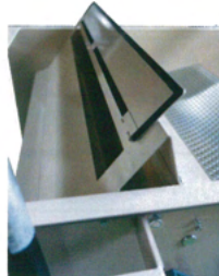
排出側除き窓
