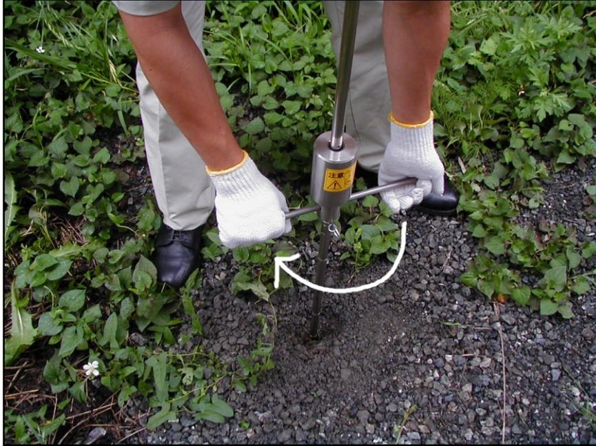
4. サンプリング部に採取された土壌の表面をヘラ付きハンドルで削り、状態を野帳などに記入します（野帳記入例参照）。必要に応じてヘラ付きハンドルで土壌を採取し、ビニール袋などに入れて分析試料とします。
