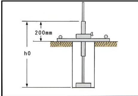
セットが完了したら試験器の目盛り (h0) を読み、野帳に記入します。この時 (h0 - 200 mm) は孔の深さとなります。
