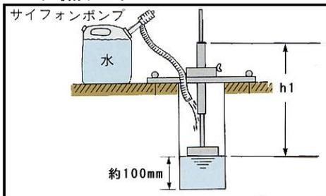
サイフォンポンプで注水用穴から水深が約 100mm 程度 (目盛りで h0 - 100mm の位置) になるようにゆっくり注水します。その時の目盛り (h1) を mm 単位で読み、同時に時刻 (t1) を記入します。
