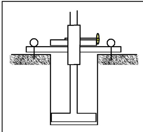
左図の様に固定ピン 2 本でホールカバープレートを固定します。
