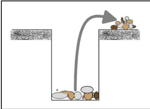
測定目的深まで掘削できたら、孔底を傷つけないように平らにし、孔内の土砂を丁寧に取り除きます。
