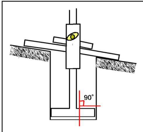
ホールカバープレートとスケールガイドを調整し、スケールが垂直になる様にしてください。その後垂直を確認し、スケールガイドが動かない様にスケールガイド固定ネジを締めてください。
