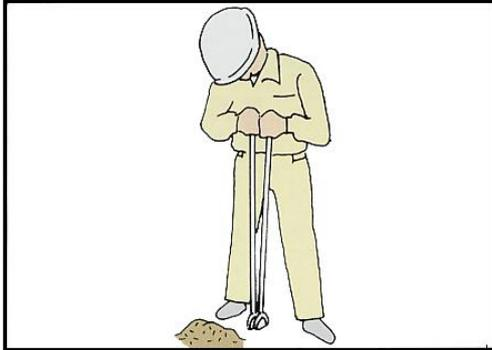
測定地点に複式ショベル（ダブルスコップ）で、径 15 cm 前後の円柱状の穴を掘削します。
