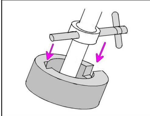
スケールガイドをスケールに通し、ホールカバープレートのある穴の溝にスケールガイド固定ネジが収まるようにします。(スケールガイドはパイプの長い方を上にします。)
